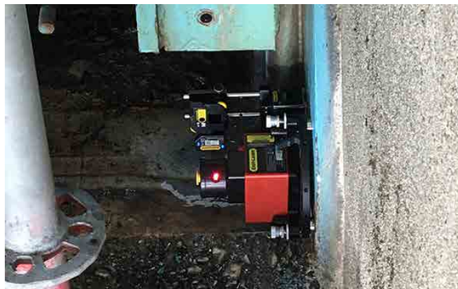
Emettitore laser D22 montato con i suoi magneti integrati sul lato della tenuta.
