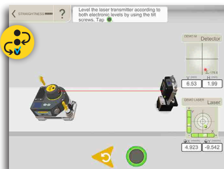
La calibrazione delle livelle di precisione elettroniche è semplicissima con la guida passo passo fornita dal software.
