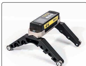
Zampe per la misura su grandi superfici cilindriche.
