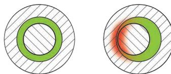
*Il film lubrificante in un cuscinetto è molto sottile. Una macchina non allineata correttamente, o una fondazione che non la sostiene in modo adeguato, causeranno una maggiore pressione e il surriscaldamento del film lubrificante. Alla fine, il lubrificante verrà distrutto e la macchina avrà un guasto.*
