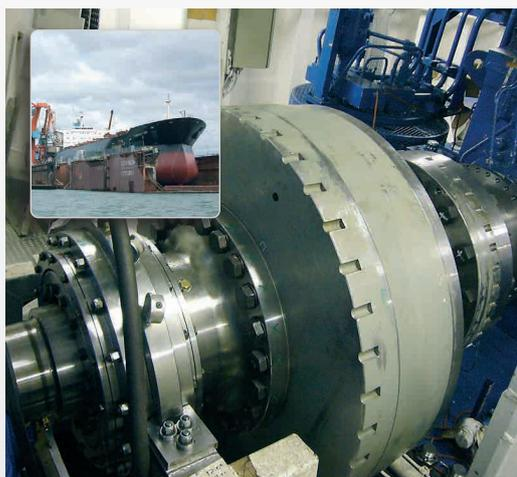
Motori, riduttori e alberi di trasmissione presenti sulle navi vengono allineati usando il sistema Easy-Laser®. Grazie alle staffe flessibili è possibile installare l'apparecchiatura nel luogo più appropriato: l'albero, il giunto o il volano.
