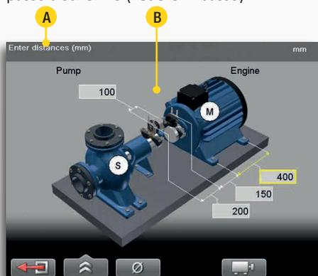
**1.** Immettere le distanze fra le unità di misura e i piedi della macchina. Immettendo il diametro del giunto è inoltre possibile ottenere il risultato come valore angolare.
