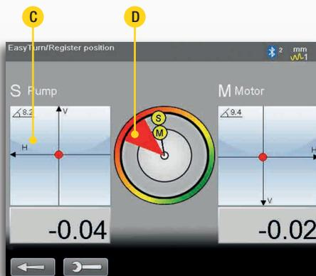
**2.** Rilevare i valori di misura in tre posizioni. Con una distanza anche di soli 20° fra di loro. Sul display è chiaramente visibile quando il raggio laser colpisce il sensore.
