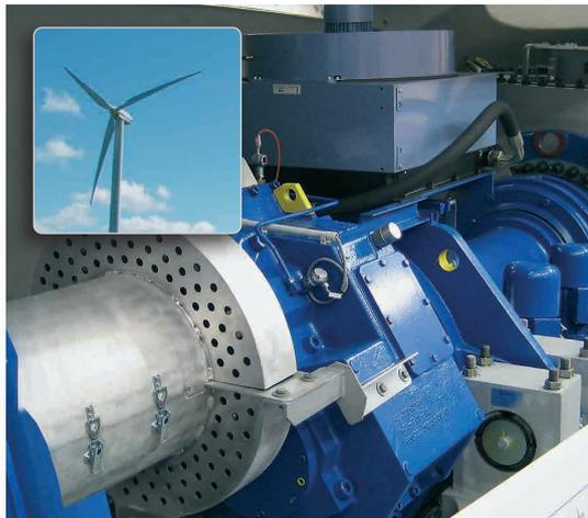
Easy-Laser® viene usato per allineare generatori e riduttori su turbine eoliche di varie dimensioni e modelli. Sono disponibili staffe speciali (accessori) per l'allineamento con rotori bloccati, in grado di incrementare la sicurezza per l'operatore.
