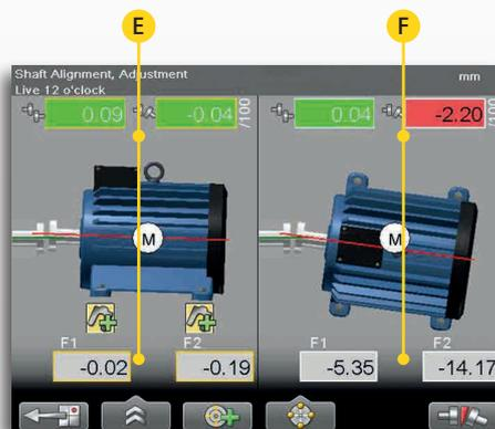
**3.** I valori di allineamento sono mostrati in "tempo reale" per effettuare l'allineamento della macchina, i valori di spostamento sono mostrati sia in forma grafica che numerica. Le direzioni di spostamento verticale e orizzontale vengono mostrate in contemporanea.
