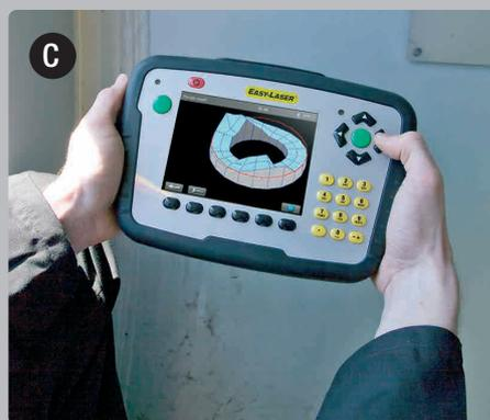
**C** Una volta registrati tutti i punti di misurazione, potete valutare i risultati direttamente nell'unità centrale. Questo può essere effettuato direttamente sul sito, senza dovervi fermare per recarvi ad un PC con programmi di analisi separati, come avveniva in precedenza. La produzione diventa quindi molto più efficiente.
