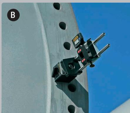
**B** Il sensore Easy-Laser® è posizionato sul punto di misurazione. Dal momento che il raggio laser ruota costantemente, non dovete fare altro che spostare il sensore in ciascun punto di misurazione e registrare il relativo valore. Nessuna perdita di tempo per il riposizionamento del raggio laser.
