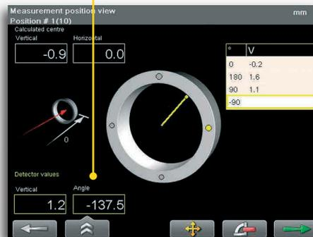
2. La grafica mostra la direzione del sensore. Viene evidenziato sul cerchio il punto di misura attivo, valore di misurazione e posizione angolare del sensore (A).
