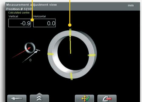
3. La regolazione dell'oggetto avviene in tempo reale. Valore verticale e orizzontale per l'oggetto (B). Vengono evidenziate sul cerchio la zona di regolazione con i valori di spostamento "live" (C).
