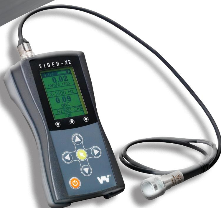
Progettato per le squadre di manutenzione e riparazione ed operatori che necessitano di uno strumento affidabile, veloce e semplice da usare per un condition monitoring in condizioni difficili. **VIBER X2™** misura Bearing Condition e vibrazioni in accordo agli standard ISO. **VIBER X2™** ha un sensore esterno con cavo lungo 1 m. Ciò rende le letture più affidabili e molto più sicure in confronto a strumenti con un più economico sensore integrato
