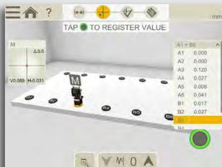
Programma di misurazione della planarità di base. Perfetto per i basamenti delle macchine, il corpo dei compressori, ecc.
